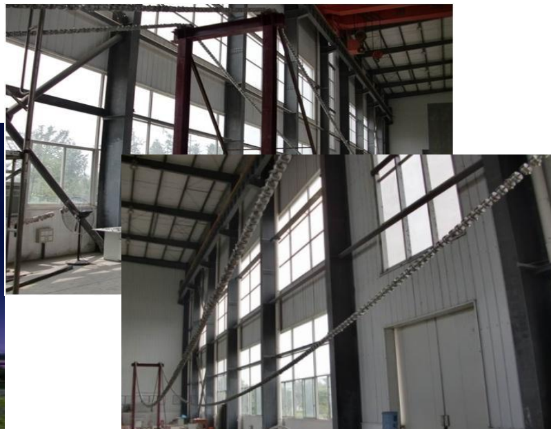
西堍门大桥主缆索股模型试验
